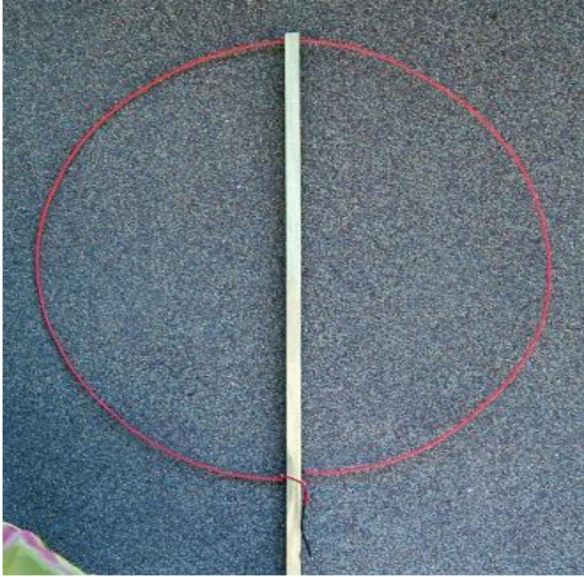
Fig.3.3 Bucle de una vuelta con cable de cobre de 6 mm 2 , con cubierta exterior de PVC.
