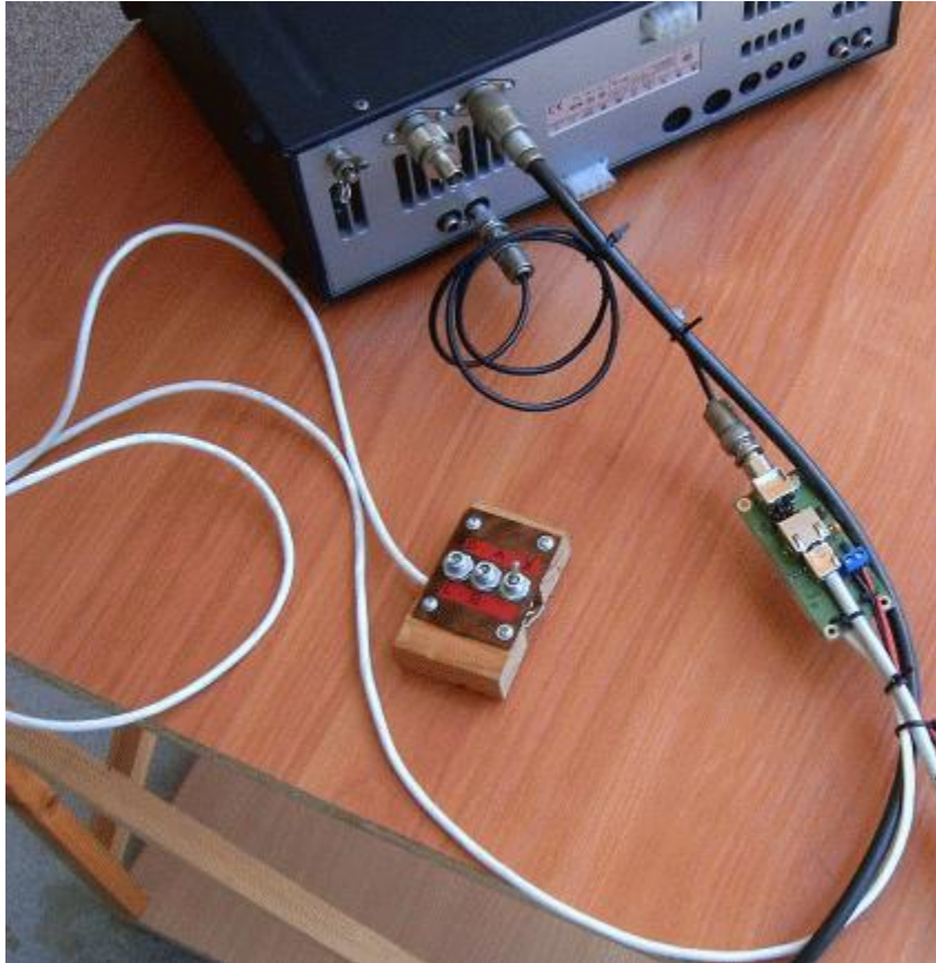
Fig. 2.9 Montaje de la placa de control sin caja.
